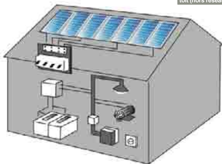
Figure 2-28 configuration d'un système photovoltaïque autonome sur toit (hors réseau)
