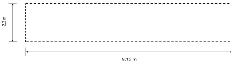
Figure 13: Limites de l'excavation vue de profil
