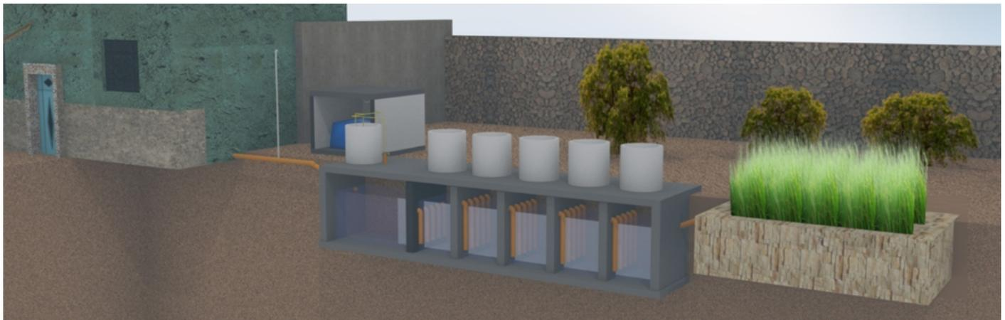
Figure 6: Unité de traitement centralisée avec production de Biogaz
