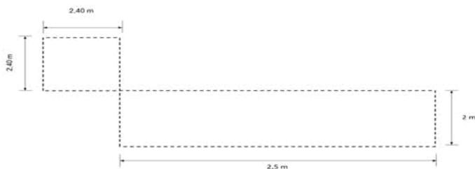
Figure 24 : Limites de l'excavation vue de haut
