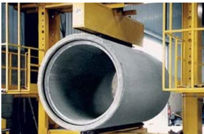
Figure 43: Principe de l'essai d'écrasement des tuyaux
