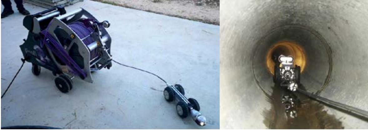
L'inspection télévisée présente cependant certaines limites : sauf défauts graves tels que grosses fissures, casses et effondrements, il est difficile de conclure au défaut d'étanchéité de la canalisation ; L'expérience de l'opérateur est ici très importante.
