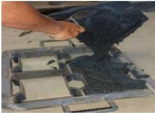
**Photo n° 8 :** *Coulée pour fabrication d'un pavé*
