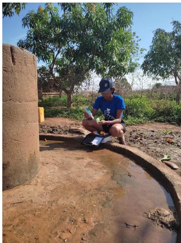
Essai de débit de l'un des puits du chef-lieu d'Ambesisika (à gauche) et prélèvement de paramètres physiques des eaux de puits à Ankazoambo (à droite). © Gescod
