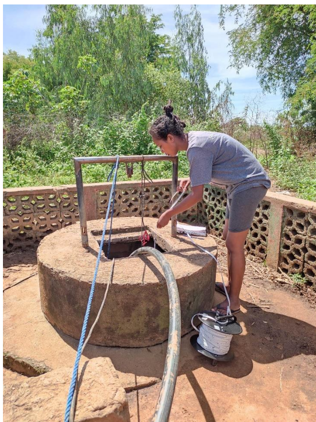
Essai de débit de l'un des puits du chef-lieu d'Ambesisika (à gauche) et prélèvement de paramètres physiques des eaux de puits à Ankazoambo (à droite). © Gescod
