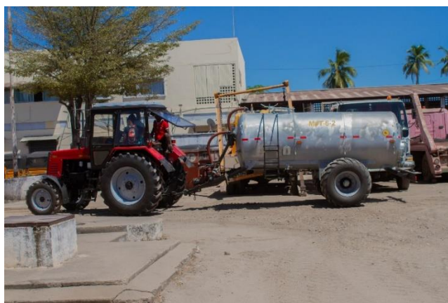
Nouveaux équipements de vidange (tracteur et tonne à lisier). © Gescod
