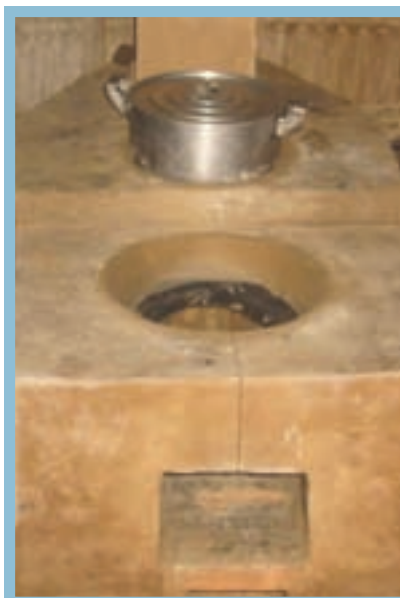
Cuiseur autoconstruit double pot, dénommé cuiseur « Samaki »
