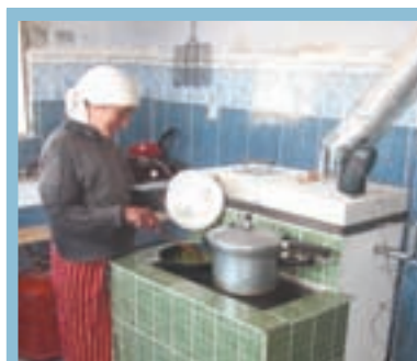
Cuisinière multifonction avec technologie CLIP en milieu rural au Maroc (© JF Rozis)
