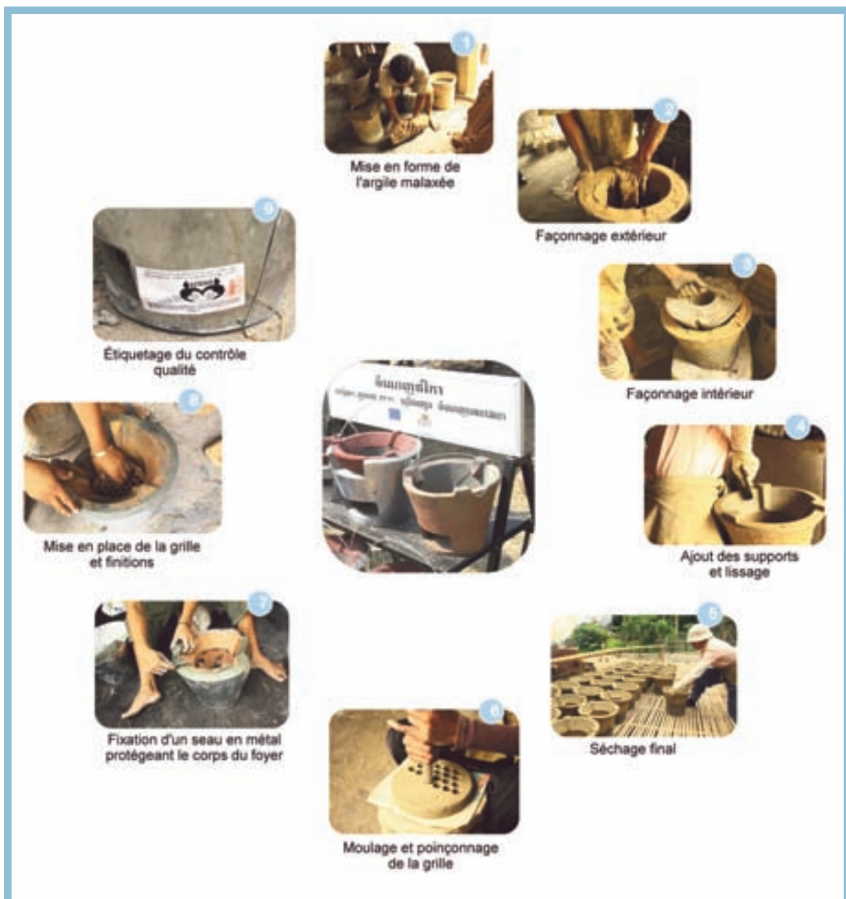
Figure 10 : le processus de la fabrication du NLS GERES (2009)
