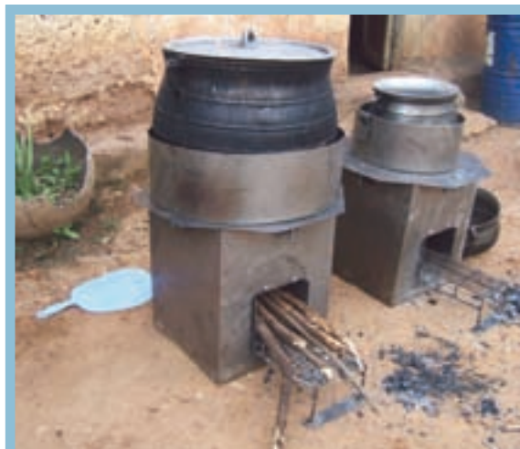
Un cuiseur de type rocket stove au Nord Bénin (© Patrick Fourier)
