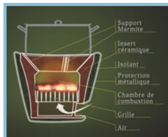
Figure 1 : le principe de la combustion montante sur grille
