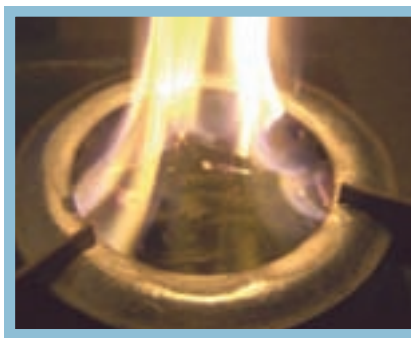
Vue de la partie haute d'un cuisinier T-LUD – flammes et formation du charbon
