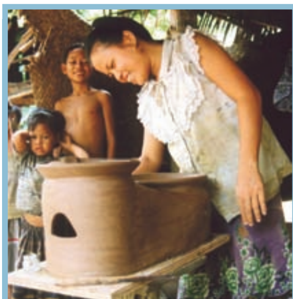
Cuiseur commercial double marmite, dénommé « Twin stove »
