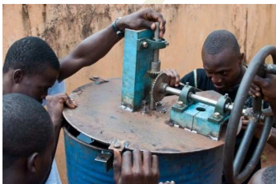
Figure 5 : Couvercle et système de transmission
