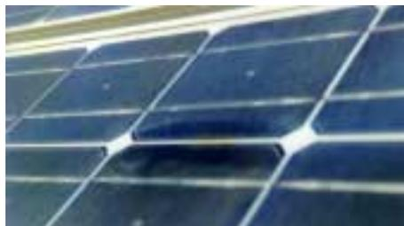
Figure 58. Jaunissement des modules sur le générateur de Oum Erromane.
