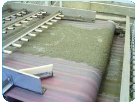
► Boue floculée sur table d'égouttage
