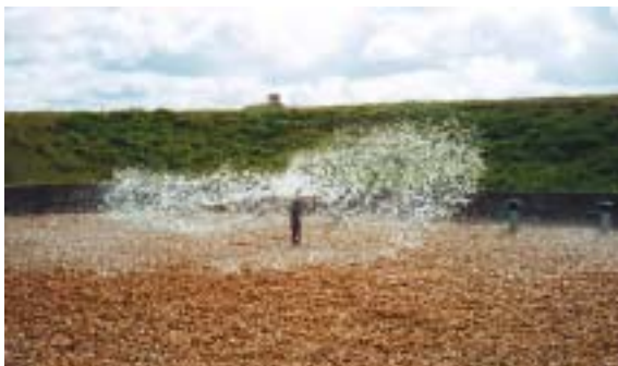
Figure 19 – Photo du répartiteur R1 et résultat de la répartition (R2 court-circuité) sur le filtre à gravier (l'essai 2 correspond à une vanne de retour vers B2 un peu plus ouverte).
