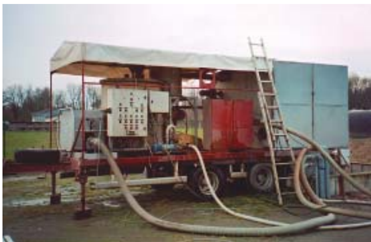
Photo 1 – L'unité mobile de traitement primaire en service à La Celle-Guénand
