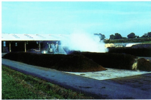
Le compostage des boues est un procédé reconnu comme hygiénisant. La bonne conduite du procédé est toutefois déterminante pour assurer une température au moins égale à 55° C, pendant cinq jours consécutifs, en tout point de la masse. La vapeur qui se dégage lors des retournements témoigne d'une intense activité thermique. Dans le cas des boues d'épuration, le compostage par ventilation forcée garantit une meilleure maîtrise des odeurs.
