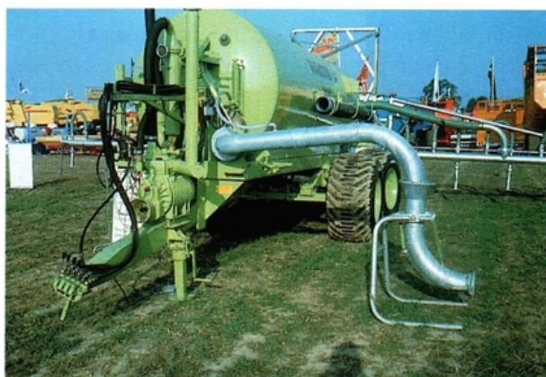
Bras de pompage latéral sur tonne à lisier, avec entonnoir récepteur. Ce dispositif évite le contact manuel avec la boue. L'hygiène du travail s'en trouve fortement améliorée.
