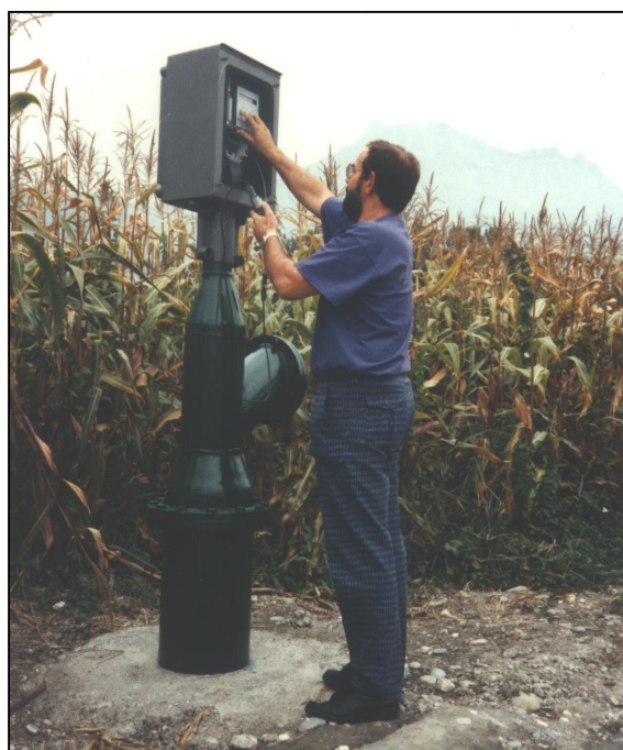
Figure 17 – Principe d'une mesure de niveau par limnimètre bulle à bulle – Photo HYDROLOGIC
