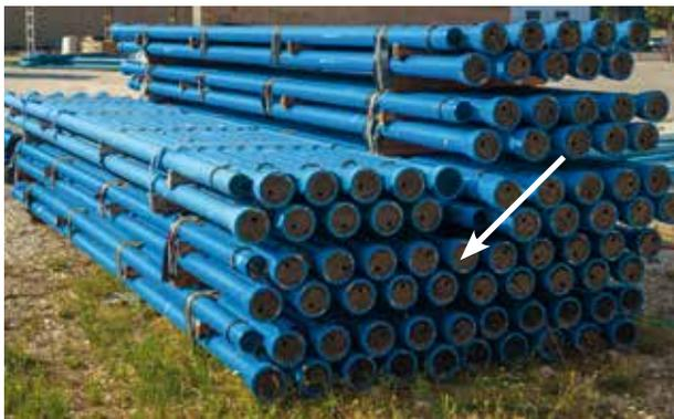
*Opercule à maintenir tant que le tuyau n'est pas posé et emboîté*
