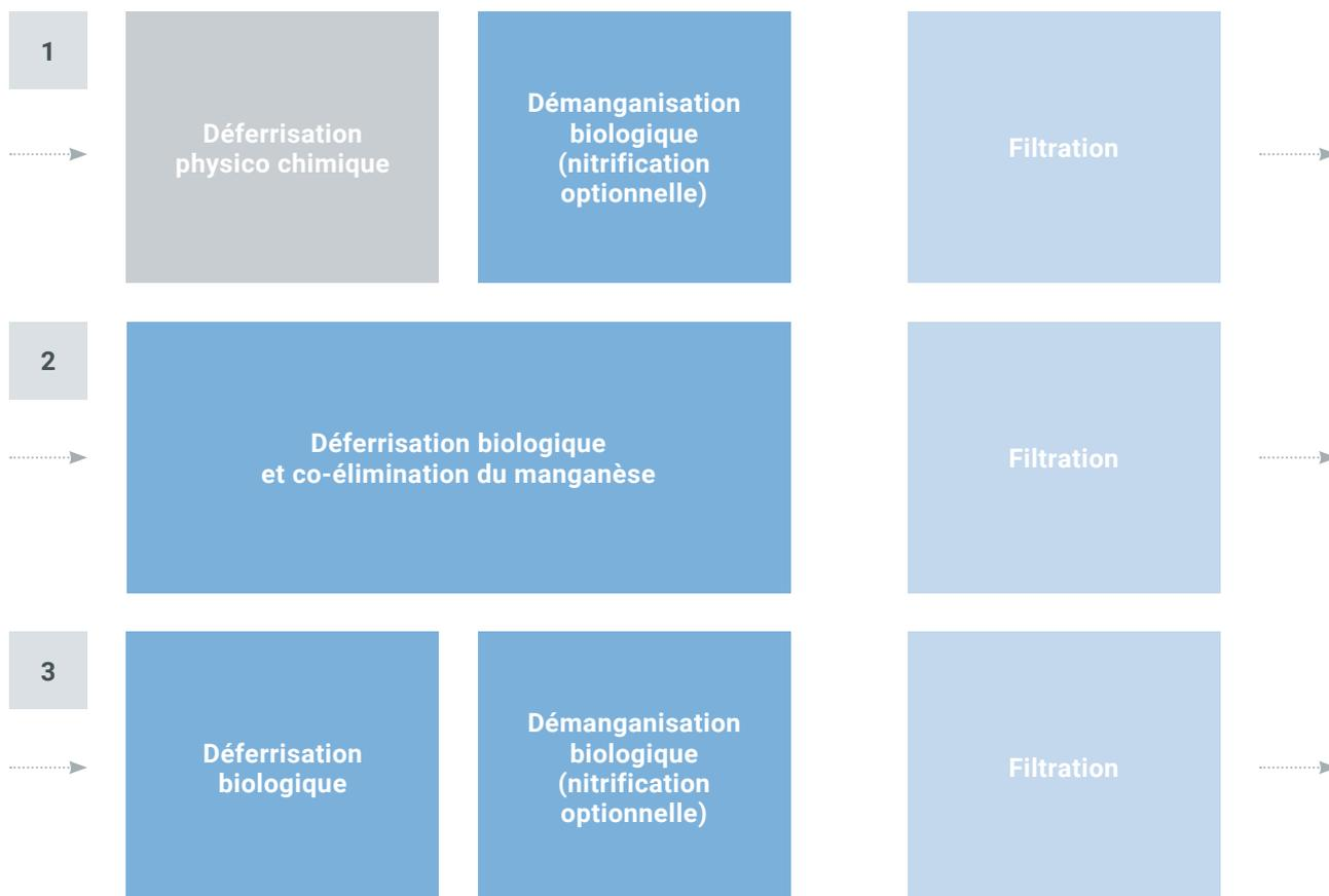
Tout traitement biologique nécessite au préalable d'êtreensemencé, il présente donc une inertie au démarrage (la performance n'est mesurée qu'à partir de cet ensemencement qui généralement s'obtient naturellement après une certaine durée de circulation de l'eau à traiter dans les filtres pouvant être de plusieurs mois).
