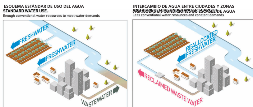
FIGURA 6.1 Ejemplo simplificado de intercambio intersectorial de aguas bajo condiciones de escasez
