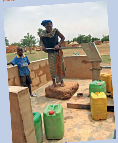
Forage avec pompe manuelle
