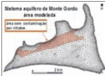
Figura 34 – Área das Hortas no sistema aquífero de Monte Gordo onde se introduziu uma concentração de \text{NO}_3^- de 4,4 \text{ g/m}^2 .
