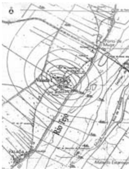
Figura 25 – Piezometria calculada pelo modelo na área do campo de captações (aquífero semiconfinado), modelo de Valada-Tejo.
