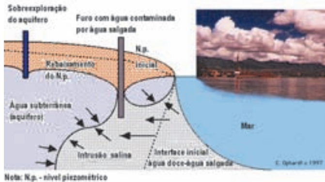
Figura 6 – Cone de rebaixamento provocado por uma captação e intrusão marinha.
