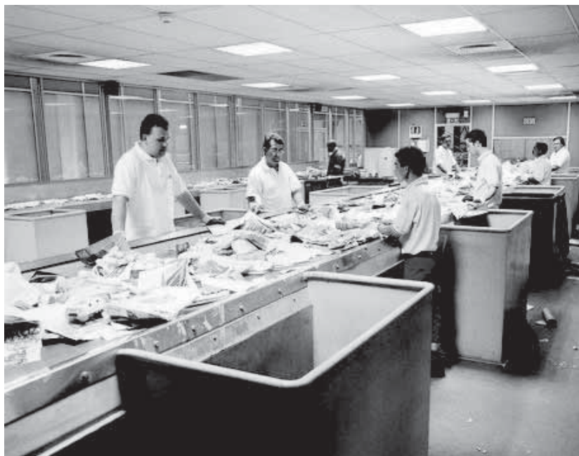
Figura 25 – Triagem em contínuo (tapete deslizante) (Ambirumo)
