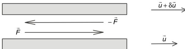
Figura 3.1 – Elementos de definição quantitativa da viscosidade do líquido
