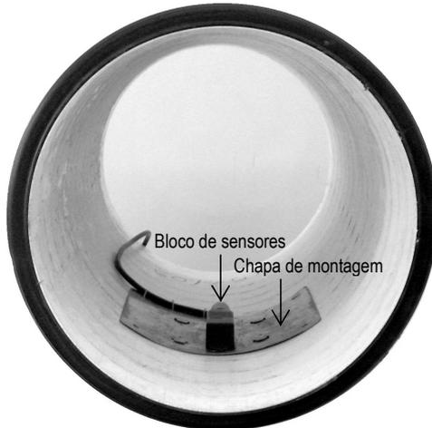
Figura 5.46 – Caudalímetro com multissensorização: exemplo de fixação do único bloco de sensores e do respectivo cabo directamente na parede interior de uma conduta por meio de uma chapa de montagem (vista no sentido de jusante)
