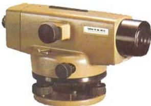
Le niveau est l'appareil employé pour le nivellement direct. L'indirect quant à lui, utilise le théodolite, que nous détaillerons dans la partie suivante (cf. §3.3.3).
