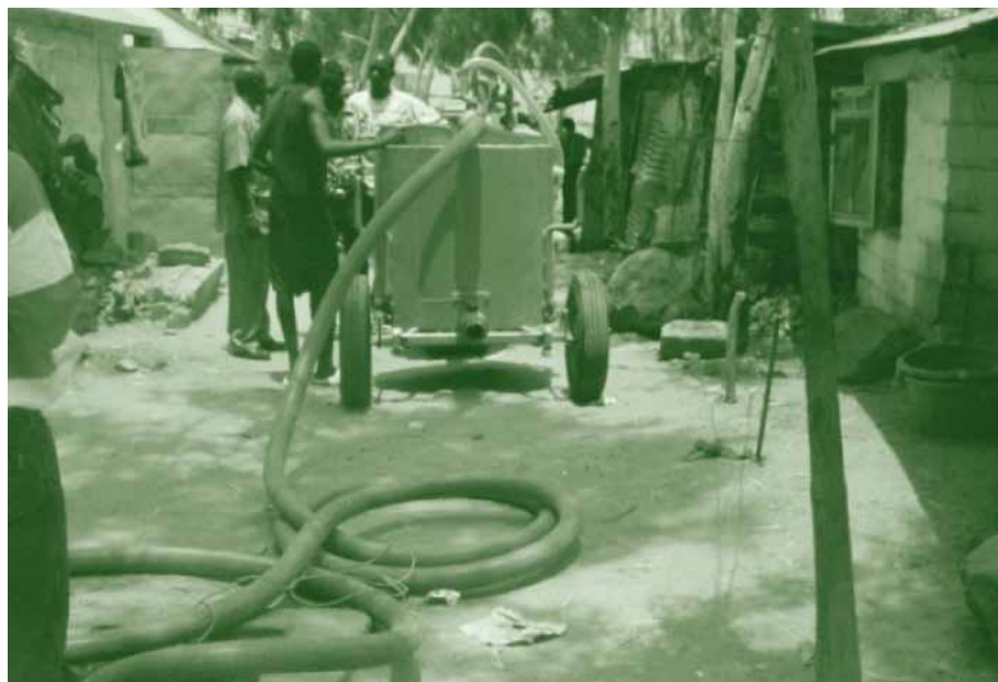
Vacutug, hydrocreuseuse conçue pour l'entretien des réseaux d'assainissement dans les quartiers denses comme Baraka
