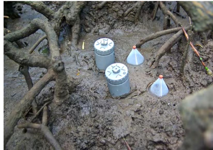
*Piégeage de NO<sub>2</sub> pour la caractérisation des processus de dénitrification*
