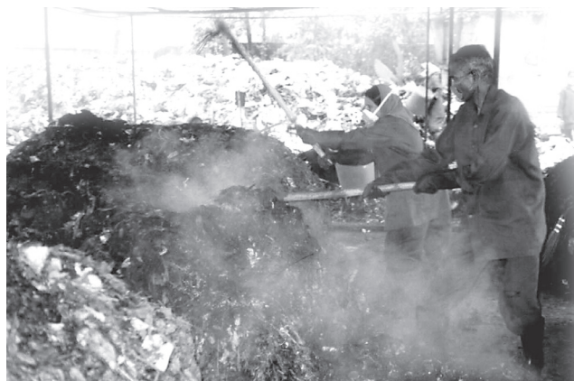
Photo 7.7 : L'andain est retourné hebdomadairement pour améliorer l'aération du tas. La vapeur indique l'élévation de température et la perte d'eau au cours du processus de compostage. (Waste Concern, Bangladesh)
