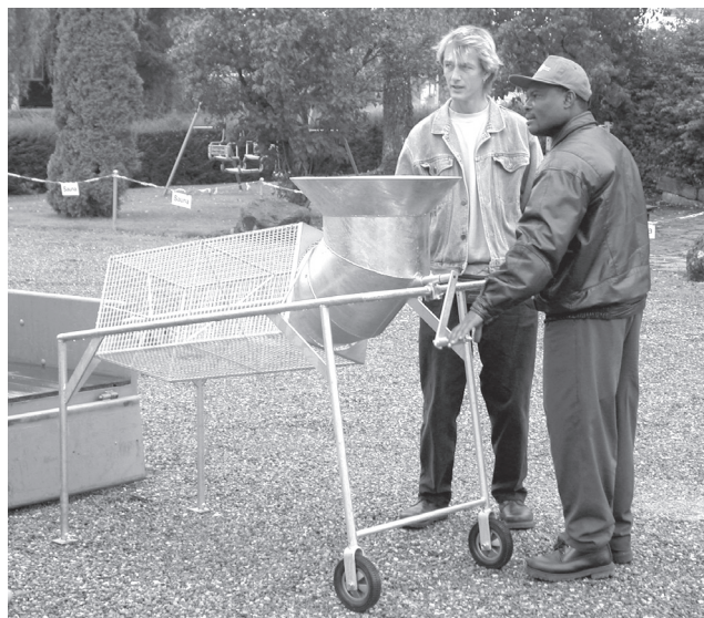
Photo 7.15 : Tamis manuel rotatif à tambour avec un tambour rectangulaire (taille de la maille 15 mm). Le compost est pelleté dans la trémie qui alimente le tamis rotatif à tambour. (CompoSieb, jbsART, Suisse)
