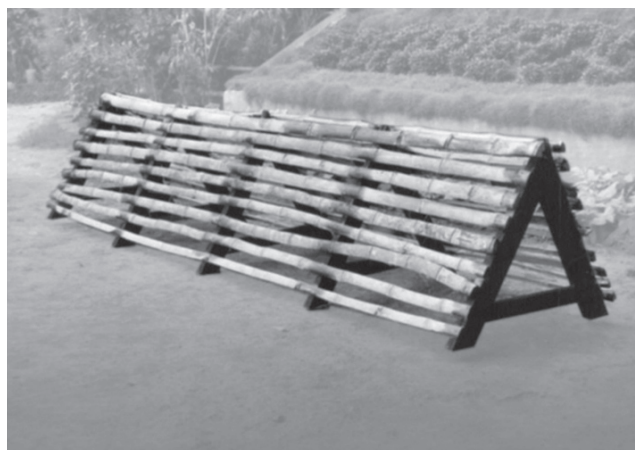
Photo 6.3 : Trou d'aération en bambou, longueur latérale du cadre triangulaire 0,6 m, longueur 2,7 m (Waste Concern, Bangladesh)
