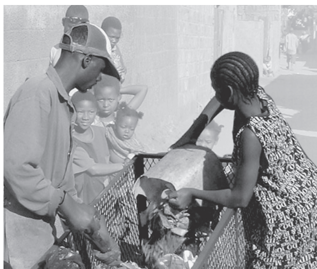
Photo 5.1 : La charrette manuelle à bras munie d'un réservoir grillagé et de larges roues a été adaptée à l'état des routes locales sablonneuses et à la forte teneur en sable. Le sable se déverse à travers le grillage réduisant ainsi le poids des déchets (AGRESU – GTZ GmbH, Maputo, Mozambique).
