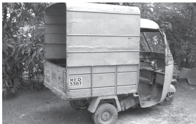
Photo 5.5 : Tree Pick-up affecté à la collecte de déchets sur de longues distances. La porte à rabattement arrière est souvent plus haute pour empêcher les déchets de se déverser (CEE Kalyan Nagar Residence Association, Bangalore, Inde).
