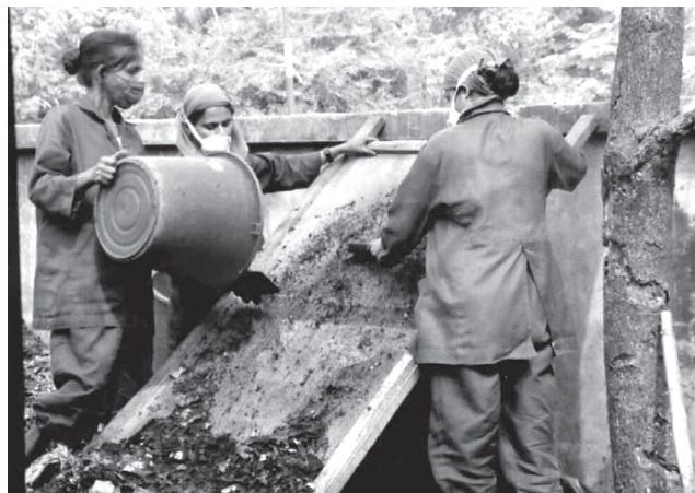
Photo 7.14 : Tamis manuel à cadre plat (0,8 m x 1,4 m) sur lequel les employés «frottent» le compost pour le passer à travers une toile métallique (taille de la maille 5 mm). (Waste Concern, Bangladesh)
