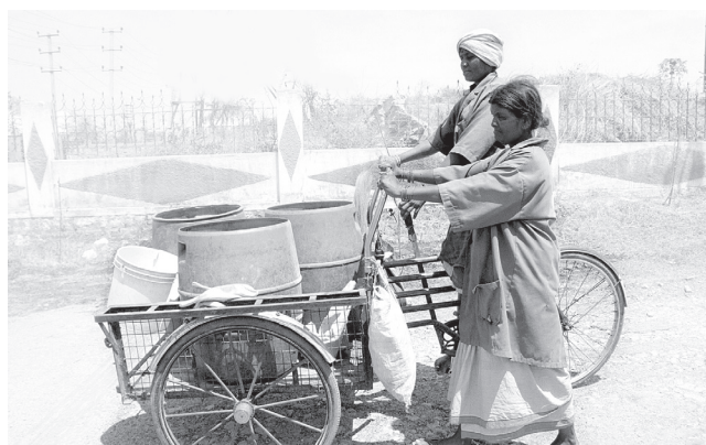
Photo 5.2 : Tricycle muni d'une chargeuse à l'avant et des contenants dans lesquels les déchets sont séparés en trois fractions (CEE Kalyan Nagar Residence Association, Bangalore, Inde).
