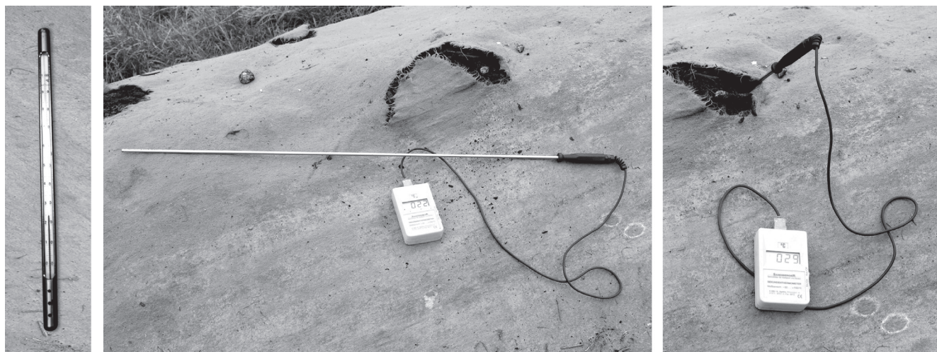
Photo 7.10–7.11 : Deux types de thermomètre : Thermomètre à alcool et thermomètre électronique avec sonde au bout (Sandec, Suisse)
