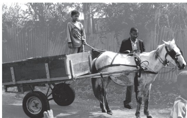
Photo 5.4 : Charrette à traction animale capable de tirer jusqu'à huit contenants rectangulaires (système d'échange de contenants) (Organisation communautaire, Agaki, Ethiopie).
