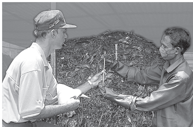
Photo 7.9 : Mesure de température à l'aide d'un thermomètre à alcool (Waste Concern, Bangladesh)
