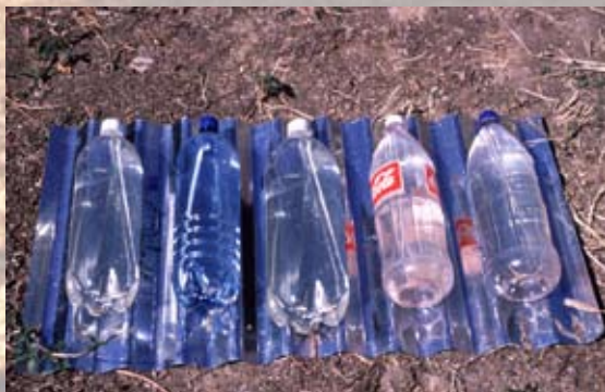
Les tôles de fer ondulé réfléchissent la lumière du soleil et offrent également un support idéal pour SODIS.
