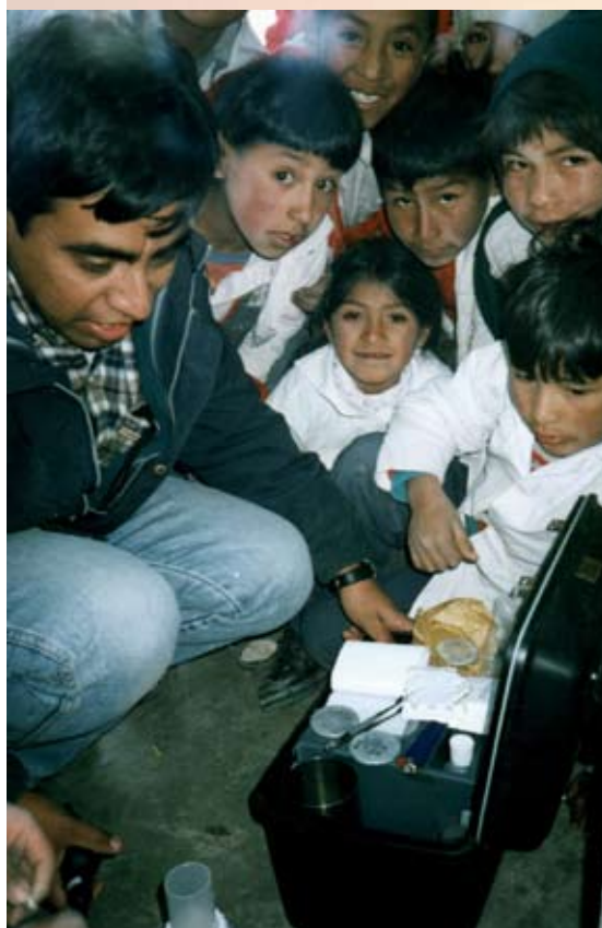
Utilisation du kit d'analyse de terrain DelAgua pour déterminer la qualité de l'eau.
