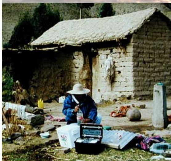
Utilisation du kit de terrain DeI Agua pour tester la qualité de l'eau traitée par SODIS, ainsi que l'eau brute.
