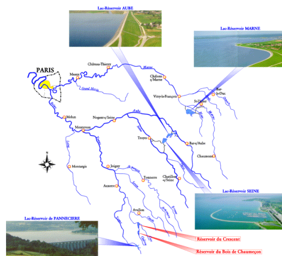
Figure 7 : les réservoirs de régulation des débits de la Marne et de la Seine (Source : Seine Grands Lacs)
