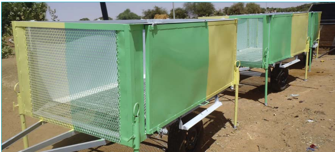
Photo 10 - Bacs d'apport volontaire de la commune de Boghé, équipés de cloisons et de fonds en tamis pour permettre au sable de se vider pendant le trajet vers la décharge
