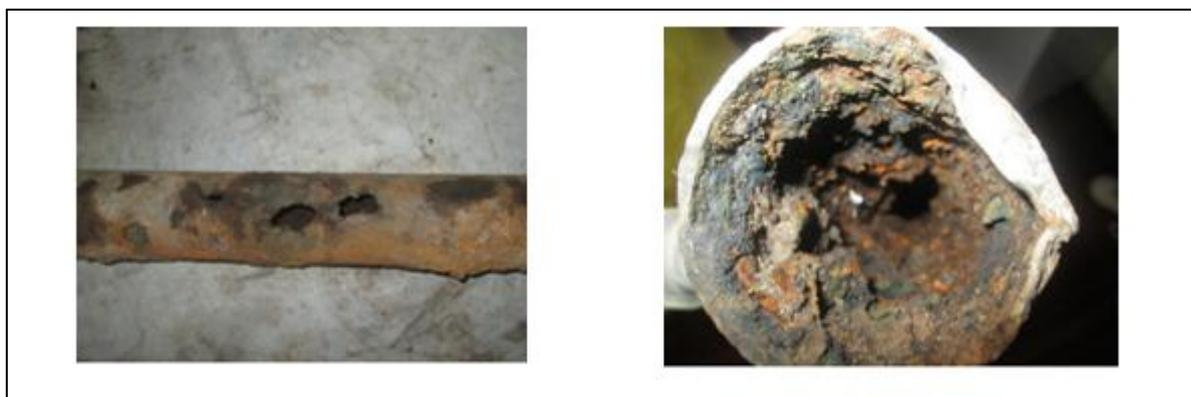
**Illustration 12:** Etat d'un tronçon de tuyau en galva 63 déposé du réseau vers Ambavahadimitafo
