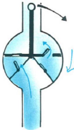
Figure 7 : Principe de fonctionnement d'une pompe à mouvement semi rotatif alternatif (Source : Office International de l'Eau, (2013), Cahier technique sur les pompes à motricité humaine )
