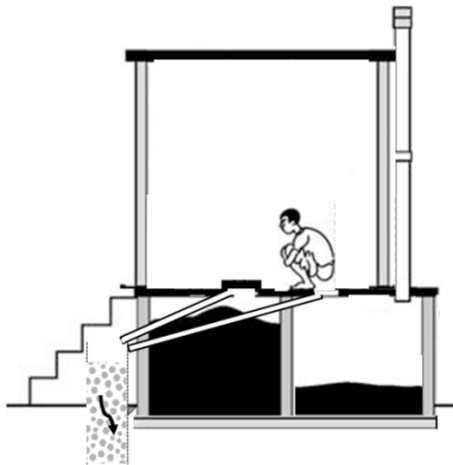
Figure 12 : Déversement des liquides dans le puits d'infiltration. Seules les fèces sont collectées dans la chambre.
