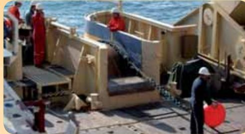
**Navire câblé pouvant tirer un câble sous marin entre l'archipel et le Canada – Sodepar**
