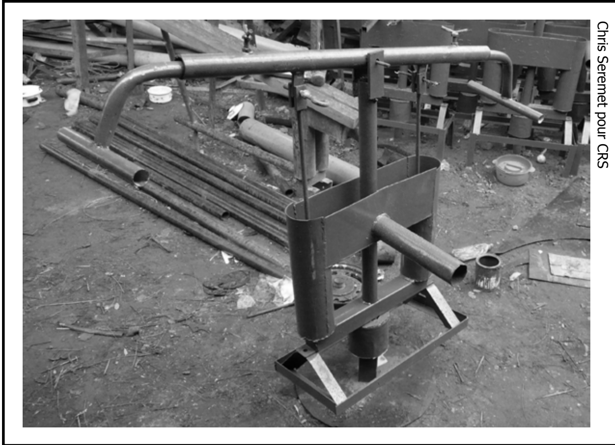
Pompe aspirante fabriquée localement au Niger.
