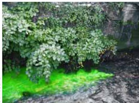
▲ Jaugeage par dilution chimique pour la mesure de débit des cours d'eau, par injection d'un traceur (ici la fluorescéine). Méthode bien adaptée aux cas des écoulements turbulents en torrents et rivières à forte pente, ainsi qu'aux milieux karstiques.
