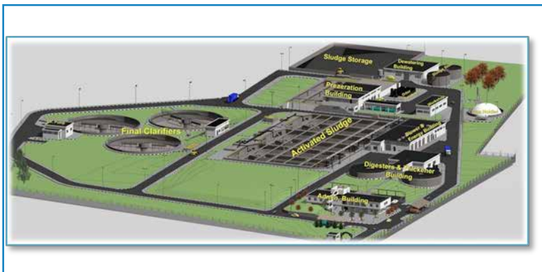
FIGURE 31 : Maquette de la station d'épuration de Jabalya – ICID 2015
