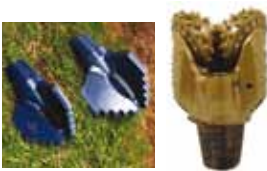
Figure 8. Deux types courants de trépan : à gauche, deux trilames, à droite un tricône
