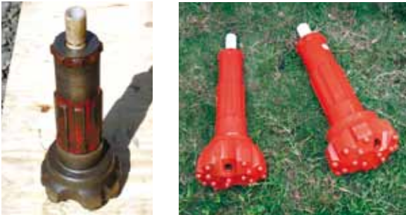
Figure 9. MFT à pastilles de carbure de tungstène. Le corps du marteau, dans lequel il glisse, n'apparaît pas
