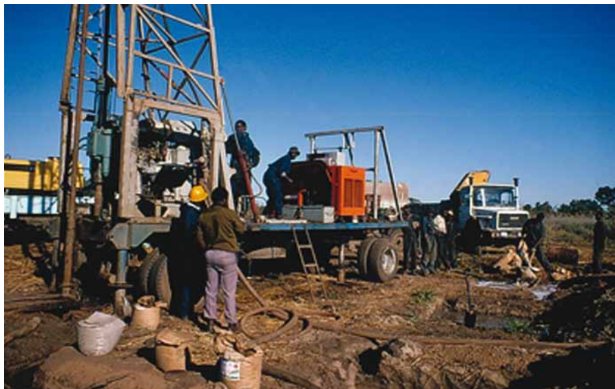
Figure 2. Machine de forage rotari à la boue, dans l'est du Zimbabwe, 1996. Remarquez les fosses à boue creusées à proximité
