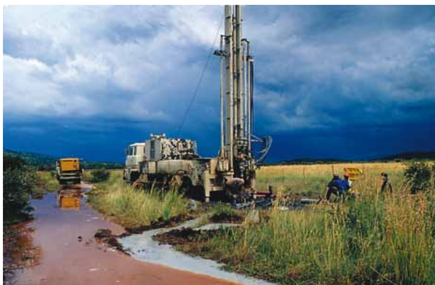
Figure 3. Machine de forage rotari à l'air en fonctionnement, Afrique du Sud, 1989
