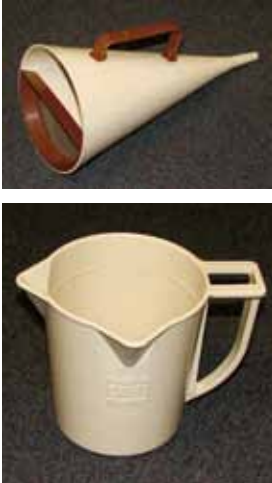
Figure 11. Le viscosimètre « entonnoir de Marsh ». En haut: vue d'un filtre intégré à l'entonnoir. En bas: mesure graduée en plastique de 1000 ml qui porte également la marque du quart (946 ml)
