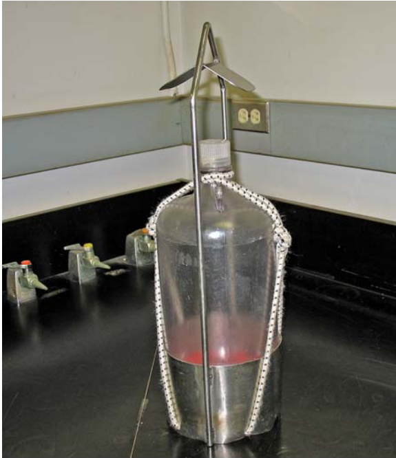
Photo 13: Exemple d'échantillonneur de 4 litres. (Avec l'aimable permission de Darcy McDonald, Alberta Environment.)
