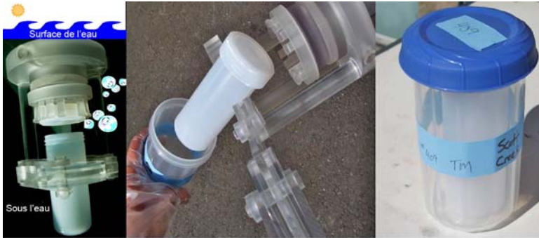
Photo 12. Échantillonneur ISOMET sous l'eau. (Source : Environment Canada, ébauche de 2008.)
