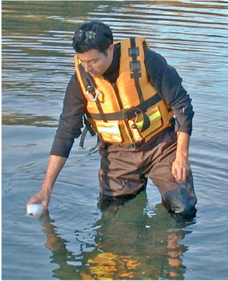
Photo 6. Prélèvement d'un échantillon à gué. (Environnement Canada et B.C. Ministry of Water, Land and Air Protection, 2005)
