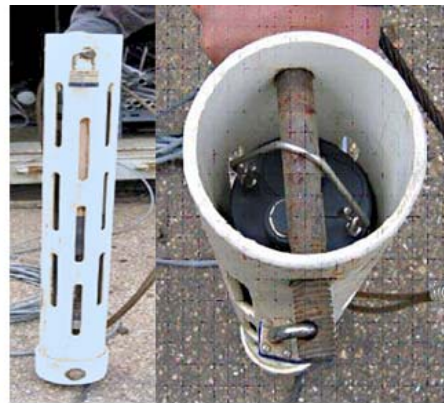
Photo 9 (à gauche). Appareil à sondes multiples équipé d'un racleur. (Source : B.C. Ministry of Environment, 2006.)
