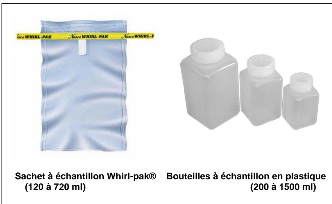
100 ml est le volume minimum d'un échantillon afin d'obtenir des résultats fiables, notamment pour les analyses microbiologiques. Davantage d'eau doit être recueillie si besoin (par exemple 200 -1000 ml), dans les cas où de multiples tests sont nécessaires.
