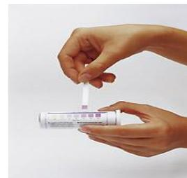
Une fois le délai de réaction écoulé, la couleur de la zone réactive est comparée avec la charte de couleurs sur la boîte afin de déterminer la concentration.
