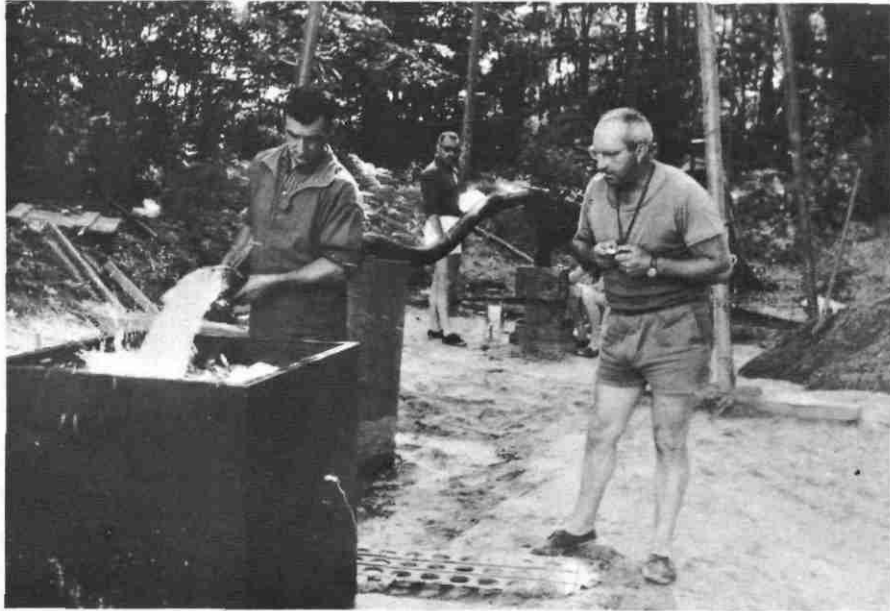
PHOTO 4 : Méthode volumétrique pour la mesure des faibles débits.
