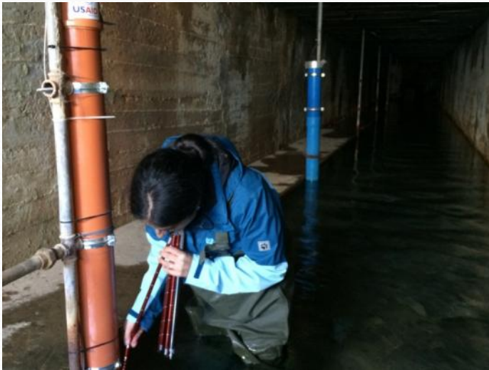
Multi Paramètre (Brand-Insitu 9500 Prof.) / Niveau d'eau, Température, Chloride, pH, and conductivité électrique etc.
