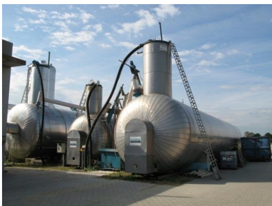
Installation de méthanisation de déchets alimentaires par Bauer Kompost GmbH à Fraunhofer.
