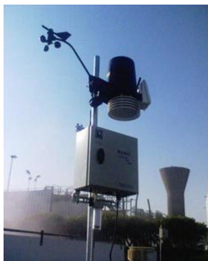
Figure 22: Exemple de nez électronique fixe installé en périphérie d'une zone odorante. Source : Alpha-Mos
