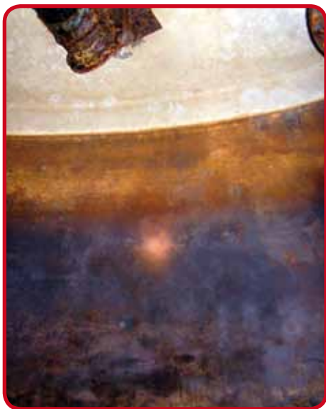
Dépôts fer - manganèse
