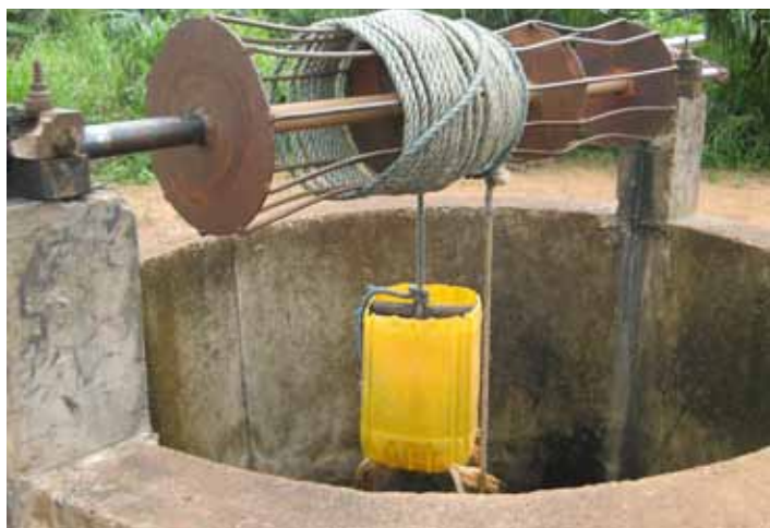
Système d'exhaure sur un puits moderne
