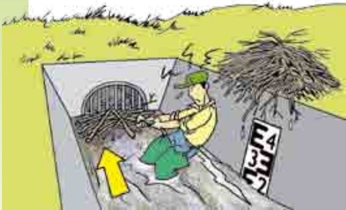
- grille d'entrée de passage busé encombrée de végétaux
