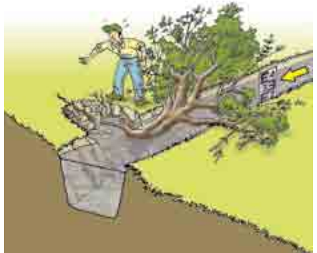
- bord de canal effondré, arbre en travers ...
