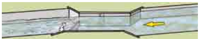
- exemple de déversoir rectangulaire à paroi mince
