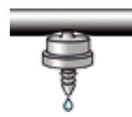
Les goutteurs se piquent sur le polyéthylène à l'aide d'une tête de vipère, ils peuvent être prolongés de micro-tubes et de piques, en simple ou double sorties. Les quadruples sorties sont à éviter : l'homogénéité de l'irrigation est moins bonne.
