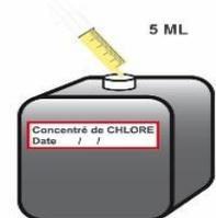
5.2. Verser les 5 ml de chlore dans le contenant des 20 L d'eau à désinfecter
