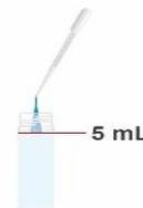
6.3. Ajouter une goutte WataBlue puis agiter le tube à essai
