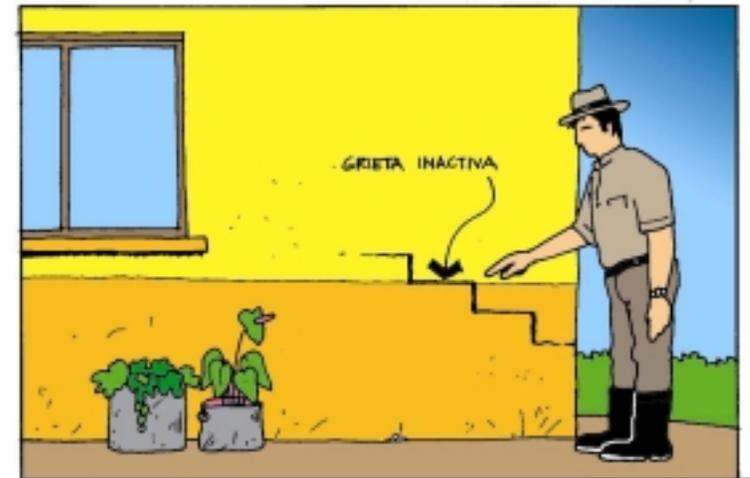
por sismos son típicamente inactivas de ahí que ellas no cambien de ancho en el tiempo. Si las grietas fueron causadas por contracción, movimientos por temperatura u otras razones este tratamiento no será efectivo. Por lo tanto se debe estar seguro que la grieta fue causada por un evento aislado.
