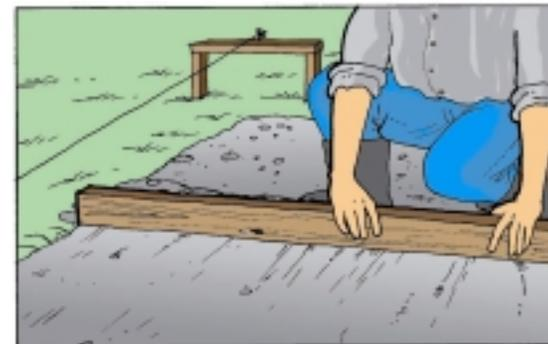
Se debe apisonar, humedecer y golpear con un pisón el terreno hasta volverlo firme y duro.
