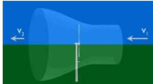
Représentation de l'augmentation de section de l'air qui traverse une éolienne. Source: windpower.org
