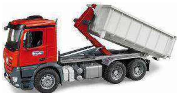
Figure 61 : Exemple de camion ampiroll
