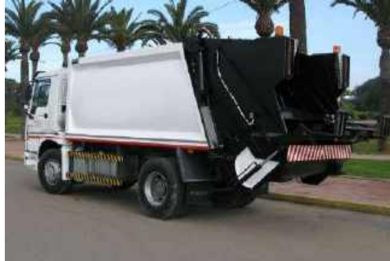
Figure 59 : Exemple de benne tasseuse
