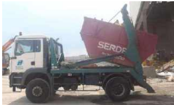
Figure 60 : Exemple de camion de collecte multi benne
