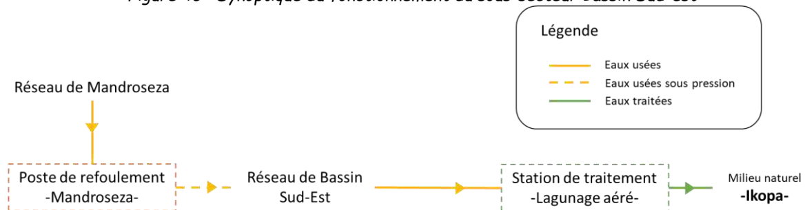
Figure 40 : Synoptique du fonctionnement du sous-secteur Bassin Sud-est
