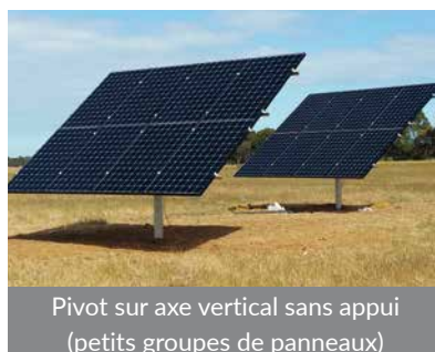
FIGURE 13 : PRINCIPAUX SYSTÈMES DE MODIFICATION D'AXE VERTICAL OU PLAN INCLINÉ (suivant l'heure)
