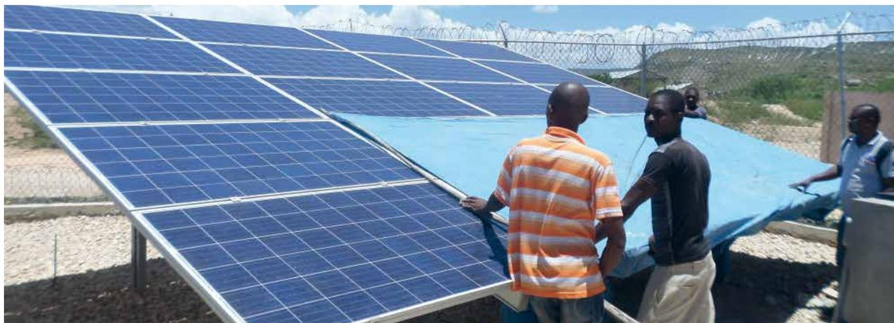
*Prueba de lona para cobertura parcial, para verificar que la bomba adapta su potencia, dependiendo de la energía solar.*
