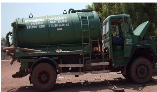
Comme ressources matérielles, le service de vidange de Benebnooma est équipé d'un camion SPIROS de marque IVECO d'une capacité moyenne de 9 m<sup>3</sup> et d'un tuyau d'aspiration de 11 m de long.
