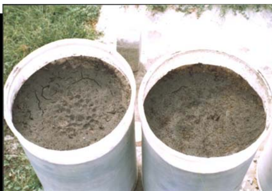
Expérimentation sur colonne de sable à l'Université d'Abobo-Adjamé : Photo 1 Dispositif expérimental Photo 2 Premier jour des surfaces de séchage huit heures après l'alimentation
