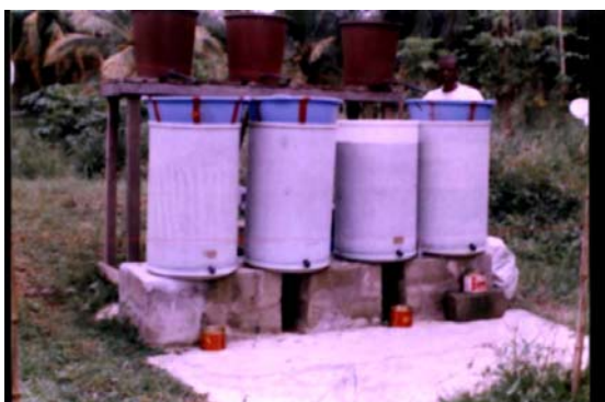
Expérimentation sur colonne de sable à l'Université d'Abobo-Adjamé : Photo 1 Dispositif expérimental Photo 2 Premier jour des surfaces de séchage huit heures après l'alimentation
